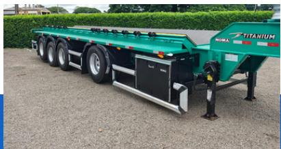
A versão standard já sai de fábrica bem completa, com caixa de ferramentas, reservatório de água de 25 litros, caixa de mantimentos com gavetas e acessórios, porta estepe para dois pneus, protetor lateral, sistema de freios a tambor e ABS, sistema elétrico com lanternas 100% em LED e suspensor pneumático no 1º e 2º eixos. As rodas são de 17 rodas com pneus 295/80R22,5. O comprimento total é de 13.500 mm, com berço de 9.000 mm de comprimento.
